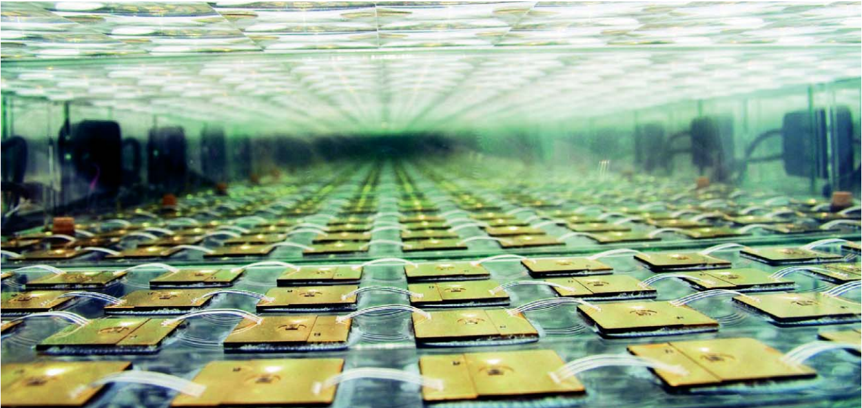
Sonnenlicht wird auf die hocheffizienten III-V-Mehrfachsolarzellen konzentriert
